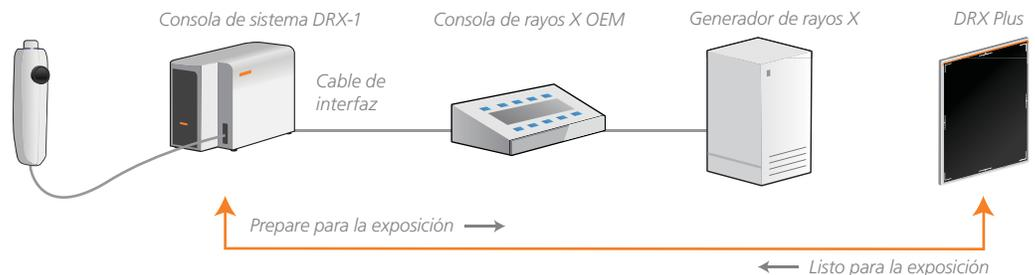
En el **Modo de detección de haz** no hay conexión con cables entre la consola y el generador OEM. El Detector DRX Plus automáticamente captura una imagen cuando la consola indica que el detector está listo y se detecta un haz de rayos X.
